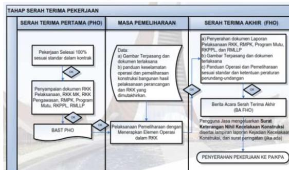
Gambar 4 : Ketentuan SMKK di Tahap Serah Terima Pekerjaan Konstruksi
