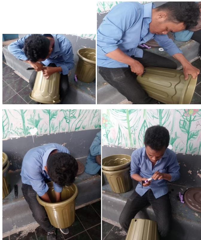
Gambar 4. Pemasangan Kran Air di Tempat cuci Tangan
