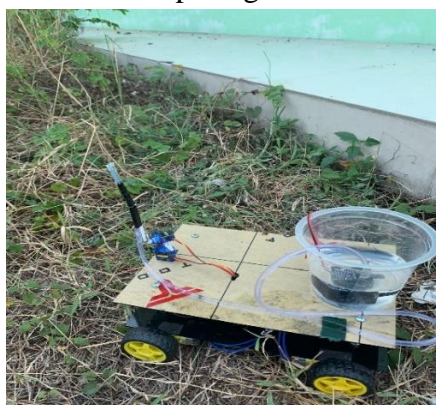
Gambar 5 alat dalam posisi siap menyemprot
