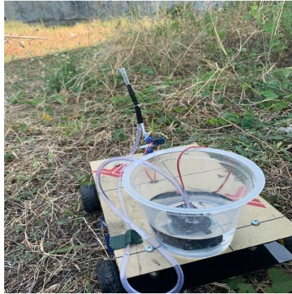
Gambar 6 alat sedang melakukan penyemprotan
