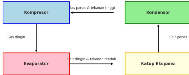
Gambar: Proses Termodinamika Kulkas
