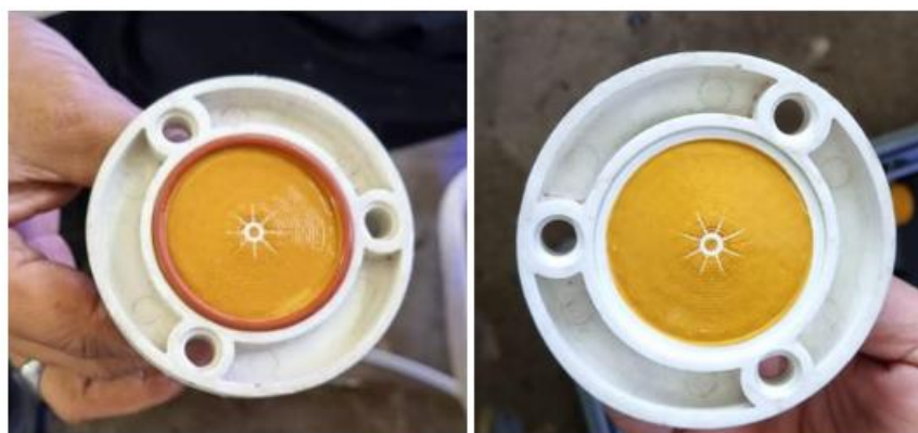
Gambar 13. Pengecekan Aktual Silt Density Index (SDI) Before Improvement pada Reverse Osmosis (RO)
