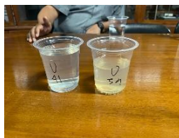
Gambar 3. Kondisi air setelah dan sebelum disaring menggunakan material yang digunakan pada tabung filter air
